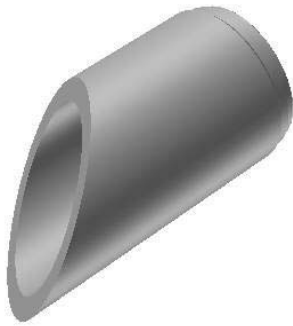
Element skarpowy wlot nachylenie 1 : 1
