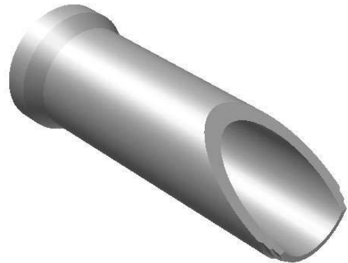
Element skarpowy wylot nachylenie 1 : 1,5
