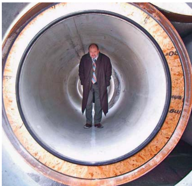
Fot. 3. Przykład rur betonowych do wykonywania przepustów metodą przecisku (fot. A. Wysokowski)
